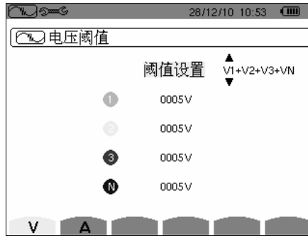
图 15: 电压阈值设置菜单
