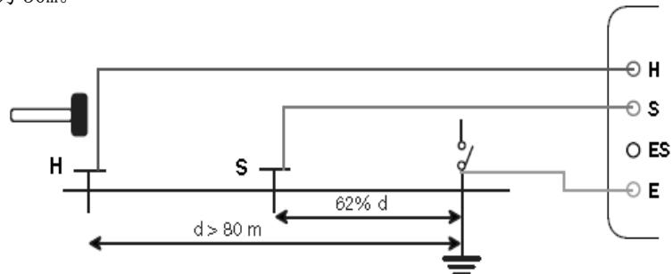
为了避免电磁干扰，最好能将测试导线从卷轴中完全拉出并保证各导线的间距尽量远，注意导线不要绕成线圈，同时，避免导线靠近或平行于金属导体（电缆、铁路、栅栏等）。将导线至测试端口 H 和 S，断开接地连接，然后连接端口 E 至接地电极开始测量。
