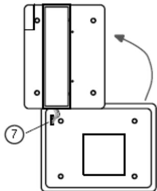
7. 取下夹盖，将电池连同4根导线一起取出(在边上，靠近光学界面). 避免接触电路和构件。
