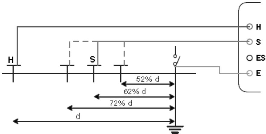
3 次测量的数值应该基本相同，数值差距也仅在百分之几的范围内，此时的测量结果是正确有效的。如果测量结果数值相差较大，说明电极 S 是在接地电极的电磁影响范围之内，此时应增加  $d$  的距离并且重新测量。
