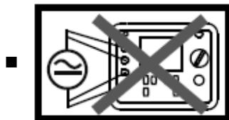
不要测量未与电网上或接地导线断开的导体。
