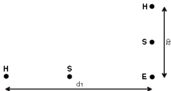
如果您经过多次测量测得了相同的数值，那么您的测量结果是正确可靠的。如果测量数值相差很大，那么可能是辅助电极受到 **感应电流** 或是地下水路的影响。此时您可以通过将辅助地桩打得更深一些和/或 将地桩周围的土壤弄湿以减小辅助电极和土壤之间的接触电阻，以增加测量的准确可靠性。
