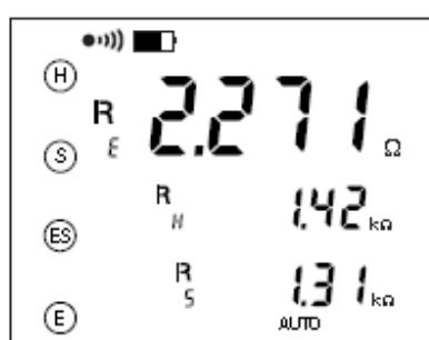
我们建议将辅助电极置于不同的距离和方向进行重复测量（见 § 3.2.1）。
