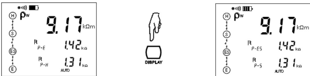
地下的金属物质（地铁线，管道等）或是地下水可能会影响给定方向的土壤电阻率。因此我们建议用户测量完一次之后旋转 90° 再做一次测量。我们同样建议使用不同的距离 d 做数次测量，以排除可能对测量造成干扰的局部作用。
