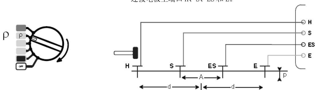
为了避免电磁干扰，最好能将测试导线从卷轴中完全拉出并保证各导线的间距尽量远，注意导线不要绕成线圈，同时，避免导线靠近或平行于金属导体（电缆、铁路、栅栏等）。
