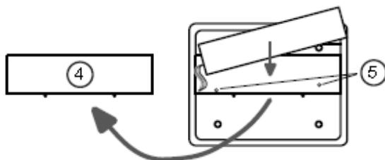
5. 将电池拉离电池箱一点点，请勿过度拉伸连接线，松开电池箱底部的两个螺丝。在将电池放入电池箱中。
