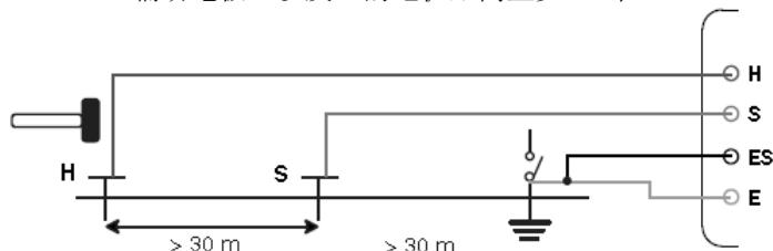
为了避免电磁干扰，最好能将测试导线从卷轴中完全拉出并保证各导线的间距尽量远，注意导线不要绕成线圈，同时，避免导线靠近或平行于金属导体（电缆、铁路、栅栏等）。将导线至测试端口 H 和 S，断开接地连接，然后连接端口 E 至接地电极开始测量。
