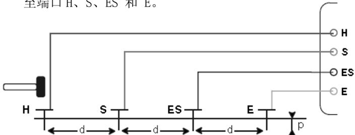
为了避免电磁干扰，最好能将测试导线从卷轴中完全拉出并保证各导线的间距尽量远，注意导线不要绕成线圈，同时，避免导线靠近或平行于金属导体（电缆、铁路、栅栏等）。
