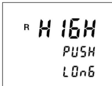
当测量是由一次短按 START/STOP 键启动的而且此时电极的电阻过高时，这个信息会显示在屏幕上。用户必须再长按 START/STOP 键，仪器将测量电极电阻并且补偿，然后显示正确的结果。
